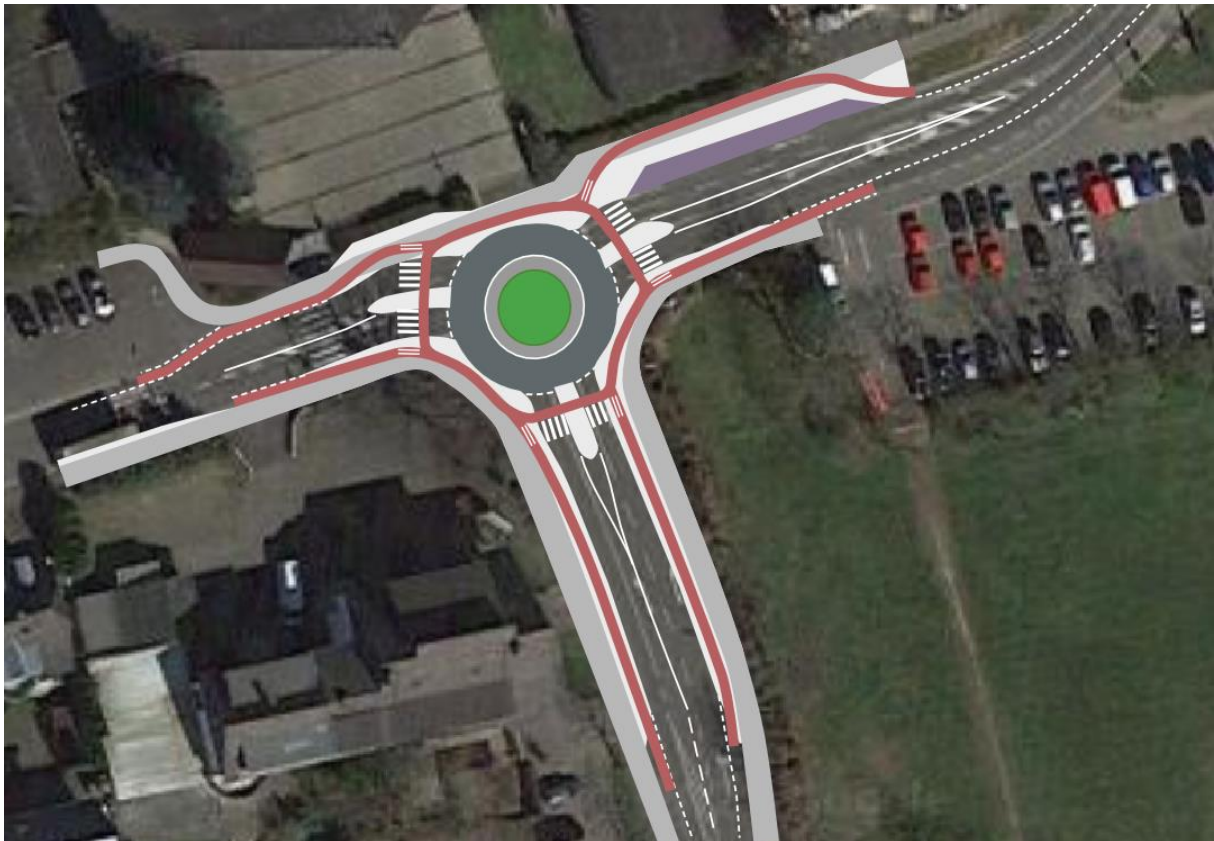
Abb. 5: Skizze Kreisverkehrsplatz an der Kreuzung Schützenstraße / St.-Pius-Brücke mit umlaufendem bevorrechtigtem Radweg; Quelle: Eigene Darstellung auf Basis von Google Maps
