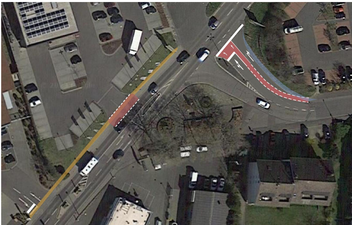
Abb.2: Skizze Schutzstreifen und vorgezogene Aufstellfläche für den Radverkehr; Quelle: Eigene Darstellung auf Basis von Google Maps
